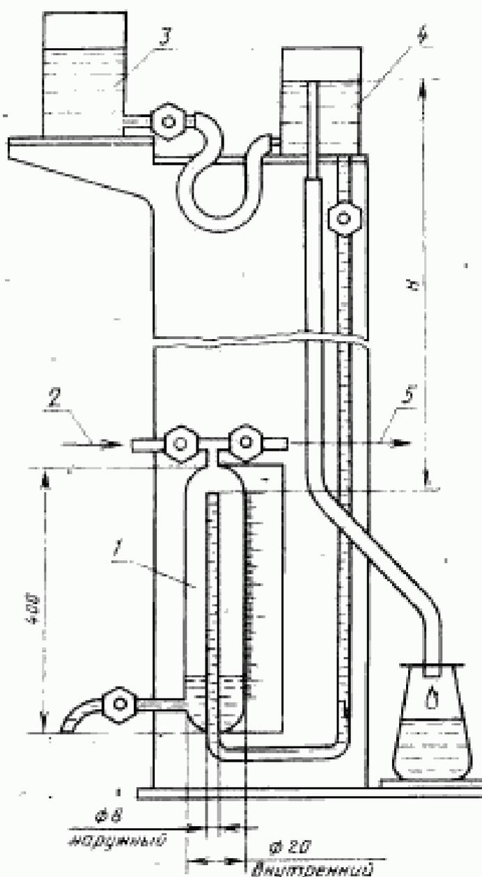
1—измерительная бюретка; 2—подвод испытательного газа; 3—резервный сосуд; 4—сосуд для поддержания необходимого уровня; 5—место подключения проверяемого аппарата; H—высота водяного столба, соответствующая давлению подводимого испытательного газа
